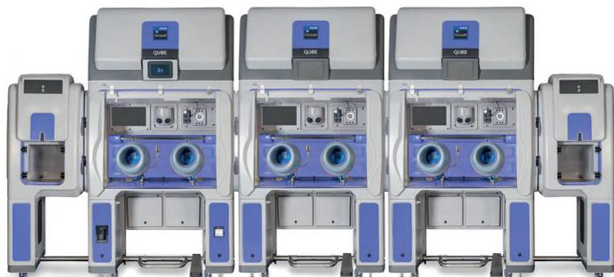
使用整合了Bioquell过氧化氢蒸汽技术的Qube隔离器,可以改进工作流程以及增加生产量。Bioquell Qube能为您快速提供无菌操作平台,并可根据需求定制2、4或6只手套的舱体。
